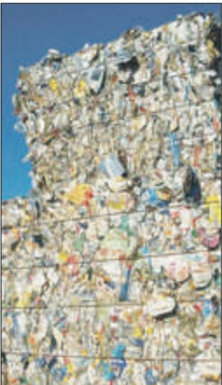
**VERWERTUNG.** Gebrauchte Kunststoffverpackungen aus den Sammlungen der DSD GmbH werden in Sortieranlagen nach den Fraktionen Folien, Flaschen, Becher, Styropor und – wie hier zu sehen – Mischkunststoffen sortiert.
